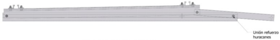
Pórtico en posición de reposo
