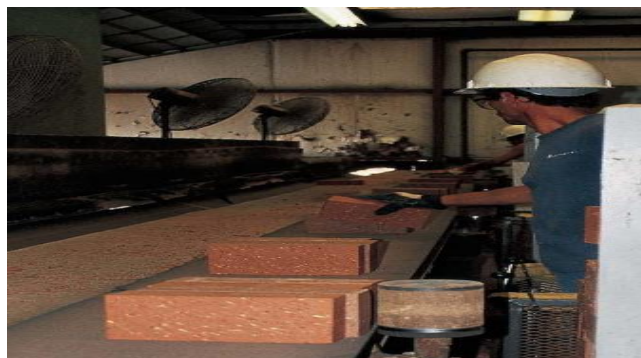
Figura 8. Enfriado y clasificación de los ladrillos de cerámica
