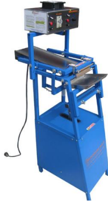
Ilustración 14 máquina de selladora semiautomática para agua en bolsa
