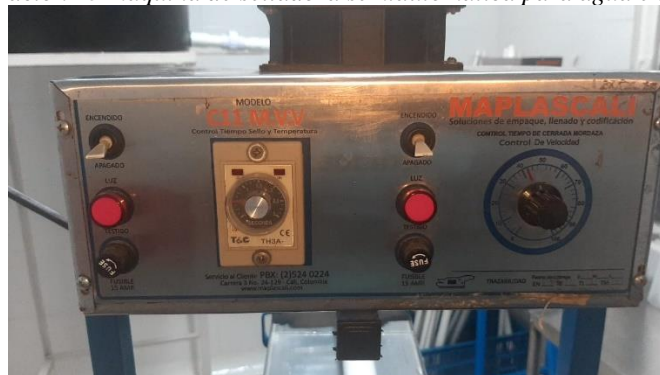
Ilustración 15 máquina de selladora semiautomática para agua en bolsa
