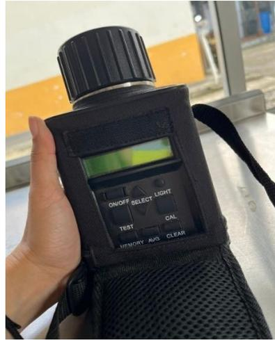
Figura 3. Medidor de humedad de café - Maquinaria Fundación Universitaria de Popayán.
