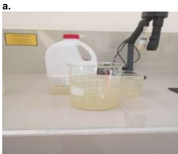
Figura 6. Caracterización del vertimiento: a) muestra de agua miel de café, b) medición de DBO 5 en el Oxitop, c) vial para la medición de DQO, d) medición de DQO en el fotómetro.
