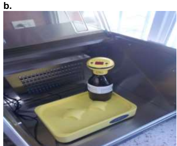
Figura 6. Caracterización del vertimiento: a) muestra de agua miel de café, b) medición de DBO 5 en el Oxitop, c) vial para la medición de DQO, d) medición de DQO en el fotómetro.
