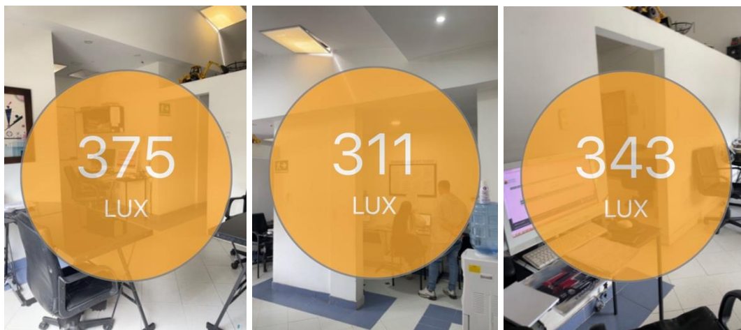
Figura 21.- Medición de iluminación
