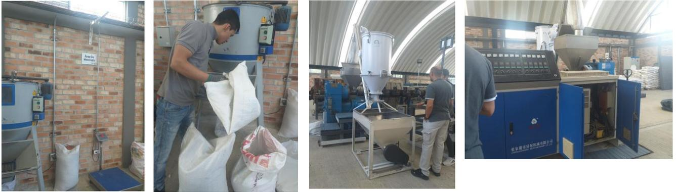
Ilustración 16. Centrifugado y Preparación de la Materia Prima para la Extracción del producto. Intersa Sas. Fuente: Elaboración Propia.
