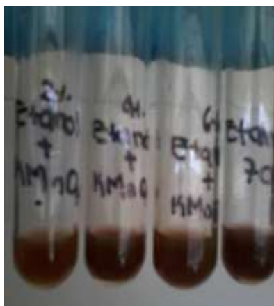
Figura 18. Prueba de oxidación con \text{KMnO}_4
