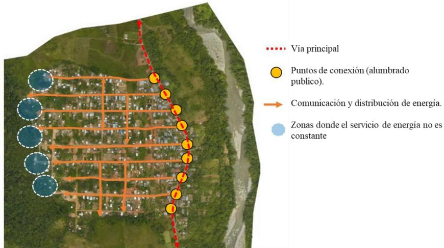
Figura 28. Esquema de suministro de energía. **Fuente:** Elaboración propia.
