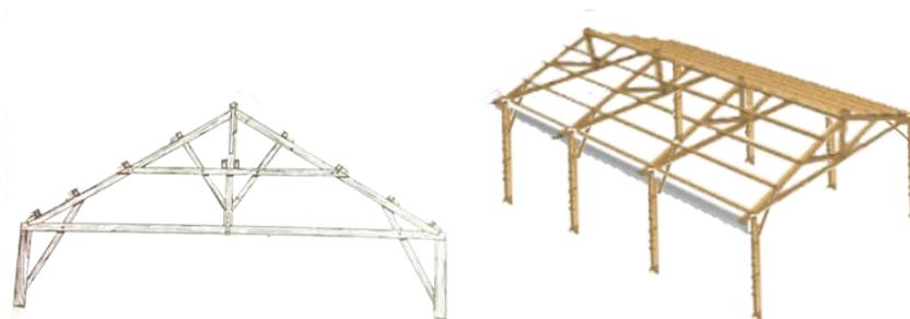
Figura 55. Modelo estructural de cubierta. Fuente: Análisis: propio complementado con investigación de: (SENA, 2018).
