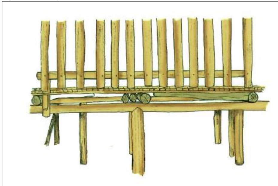
Figura 13 Anclaje tradicional final
