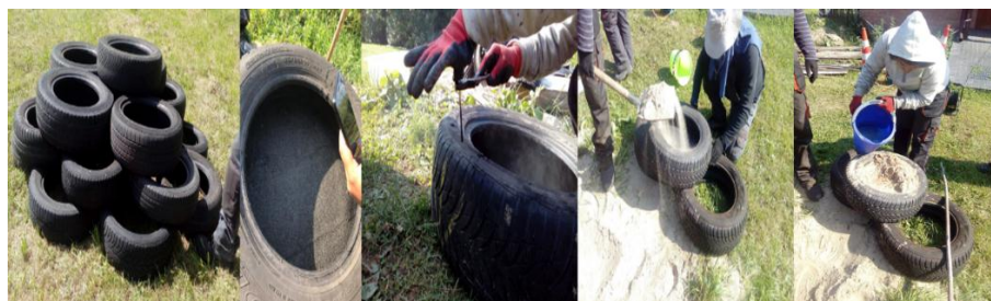
Ilustración 23. Primera parte de experimento, construcción con neumáticos de modo horizontal. A fin de evaluar modulación, peso y filtración de agua. Elaboración propia, 2019.
