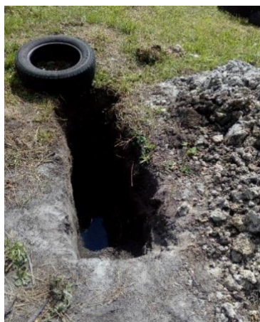
Ilustración 21. Realización de Prueba no estandarizada para la previsualización de humedad y capacidad de capilaridad, esta consiste en hacer una excavación de 0.60m de ancho por 1m de largo y 1m de profundidad. Elaboración propia, 2019.
