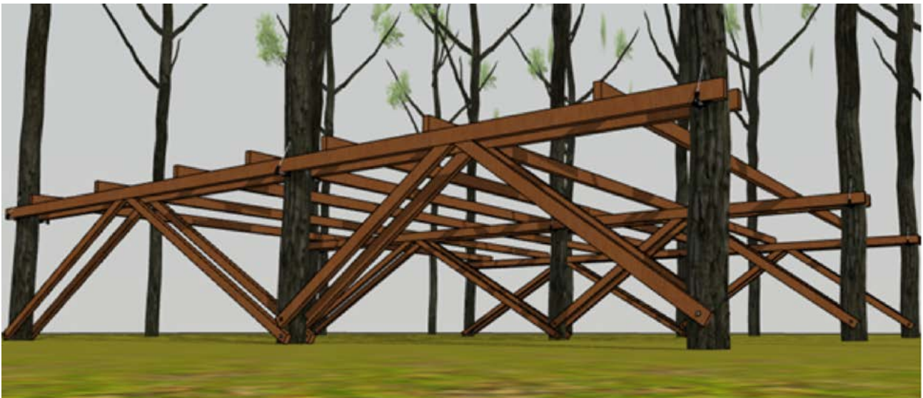
Figura 11. Visualización 3D sistema de vinculación a los árboles /// Fuente: Elaboración propia.
