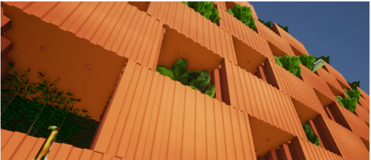
Figura 21. Termoarcilla adaptadas al huerto vertical /// Fuente: Elaboración propia.
