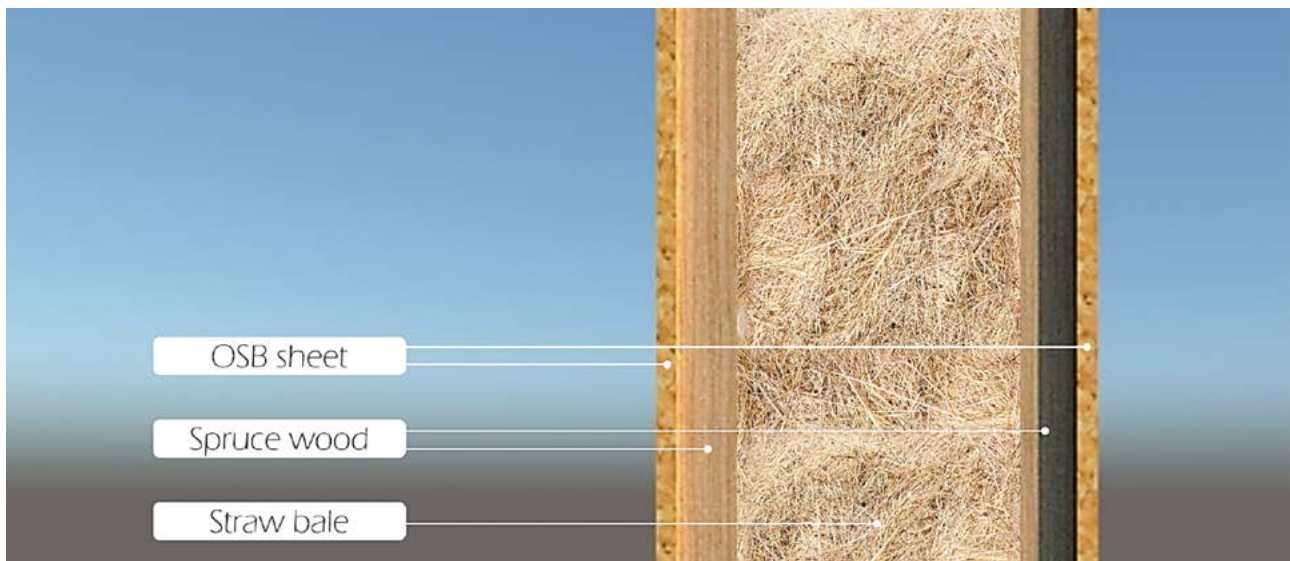
Figura 9. Sección módulo /// Fuente: Elaboración propia.
