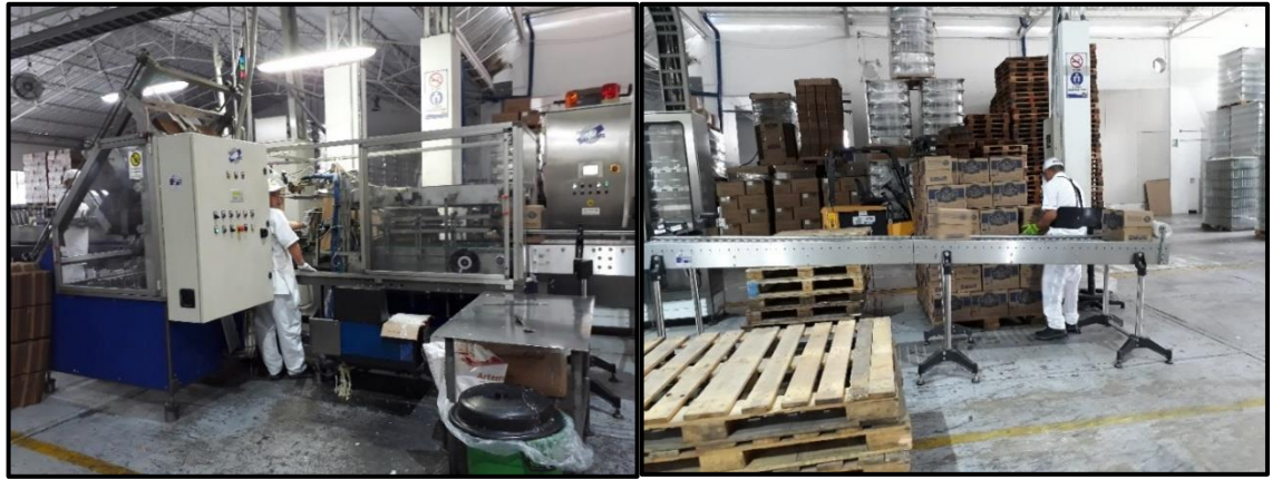
Ilustración 6. Maquina Encartonadora y recorrido hasta el embalaje del producto. Fuente: Industria Licorera del Cauca
