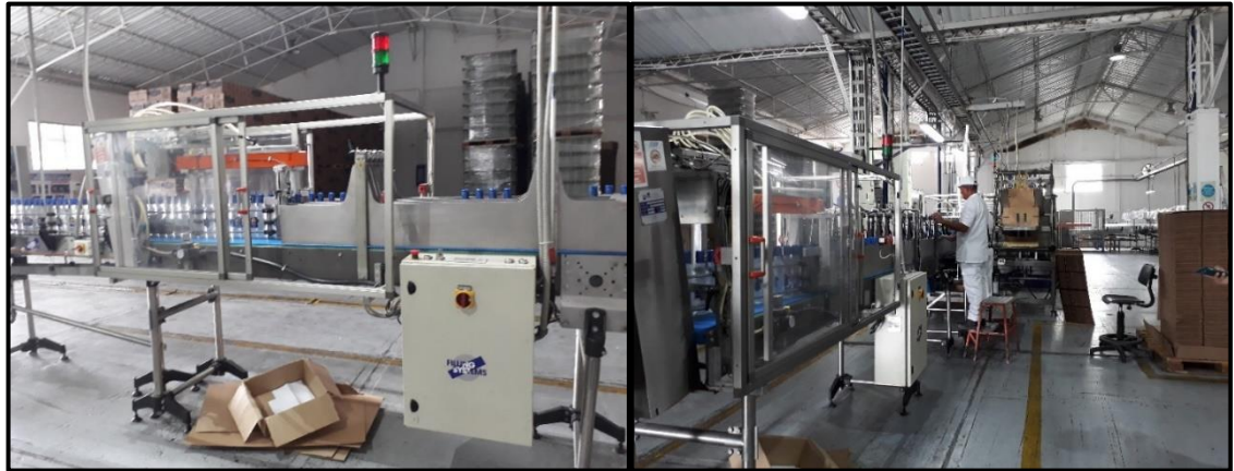
Ilustración 5. Maquina Devider y recorrido hasta la Encartonadora. Fuente: Industria Licorera del Cauca
