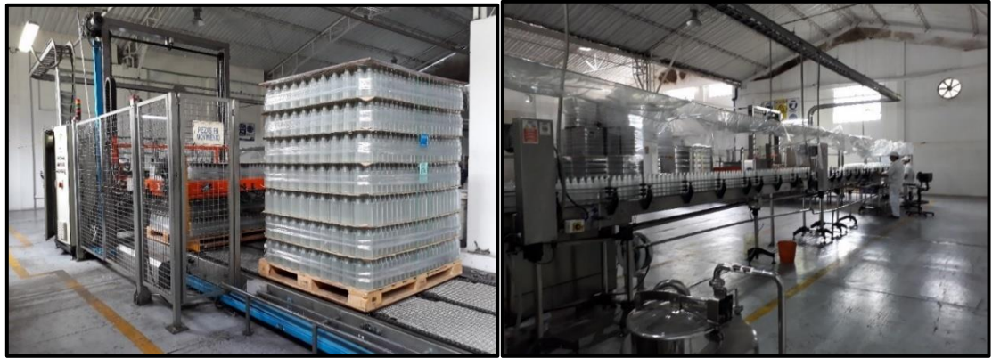
Ilustración 2. Maquina depaletizadora y recorrido Fuente: Industria Licorera del Cauca
