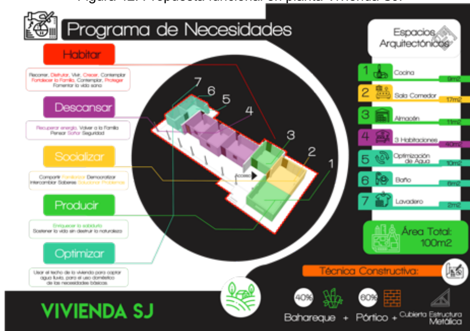
Figura 42: Propuesta funcional en planta Vivienda SJ.
