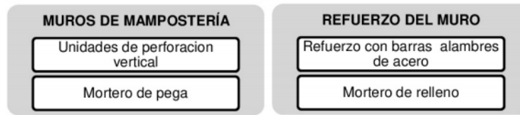
Figura 8. Muros de Mampostería y Refuerzo del Muro
