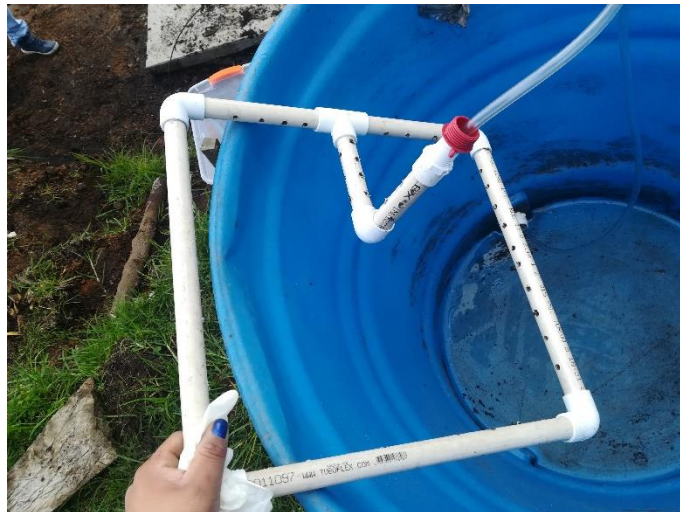
Figura 9. Tanque de cabeza constante
