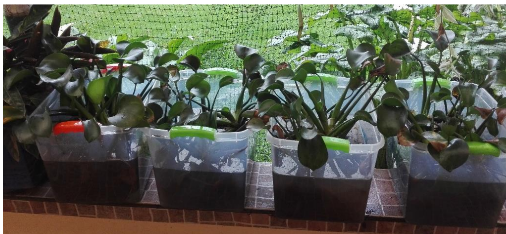
Figura 1. Humedal artificial a escala piloto
