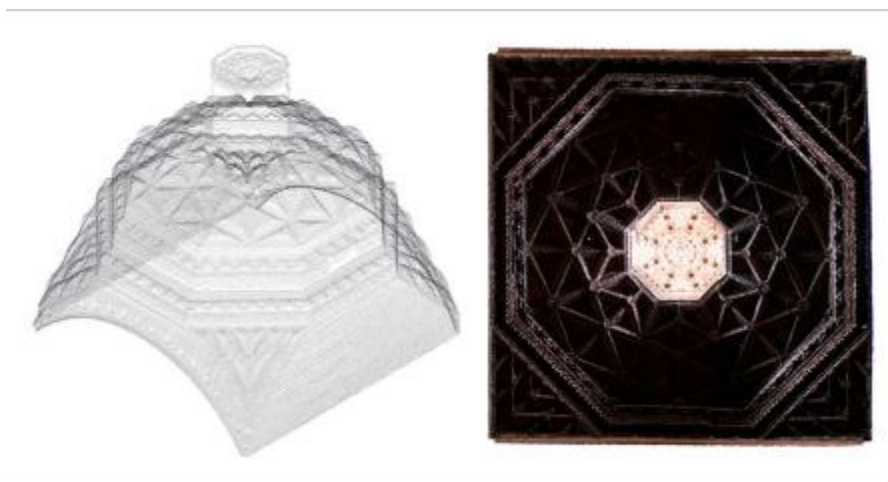
Nube de puntos a la izquierda y orto imagen a la derecha de la bóveda de madera escaneada en la iglesia de Santa María (Alejaos). Realización, Miguel Ángel Alonso. Figura 14. Fuente: Rafael Martín Talaveran.
