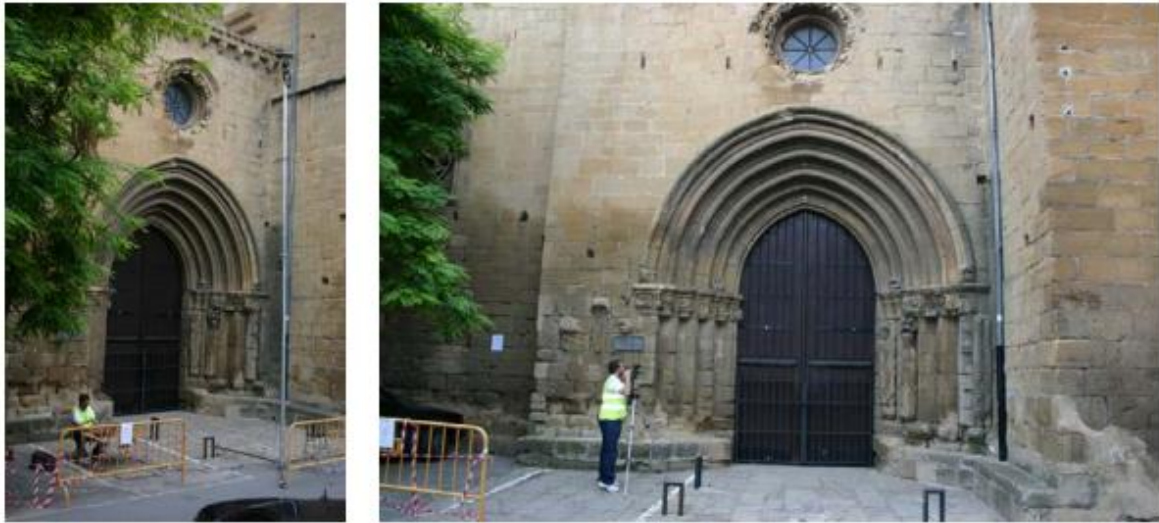
Figura 10 Fuente: Laboratorio de Documentación Geométrica del Patrimonio (Universidad del País Vasco-Euskal Herriko Unibertsitatea UPV/EHU) Dos momentos de la toma de pares fotogramétricos. A la izquierda, la cámara se monta sobre el jalón telescópico y a la derecha sobre trípode.
