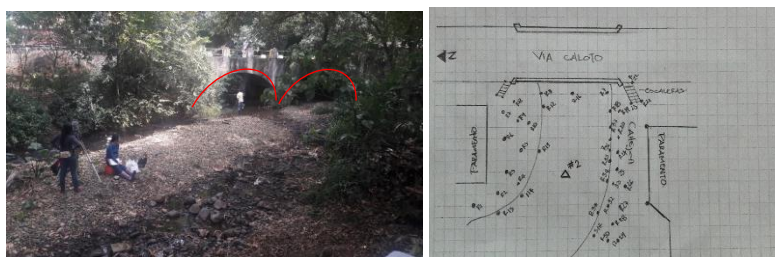
fig.26: Fuentes propias Medición de arcos que forman la estructura del puente.
