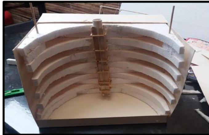
**Fig. -5:** Prototipo del recubrimiento hecho para los sensores. Pozo canadiense Biohogar, 2021 Fuente: SIE2
