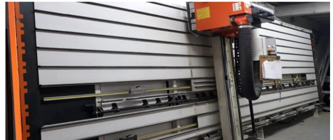
Fig. 2 Sierra vertical Marca Pusth Meniconi Referencia SVP 420.
