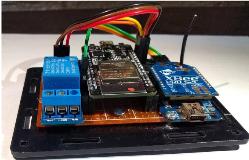
Ilustración 38 (Nodo Coordinador ZigBee Conexión)
