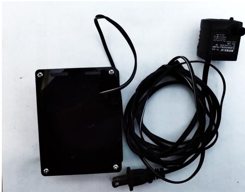
Ilustración 39 (Nodo Coordinador ZigBee Terminado)
