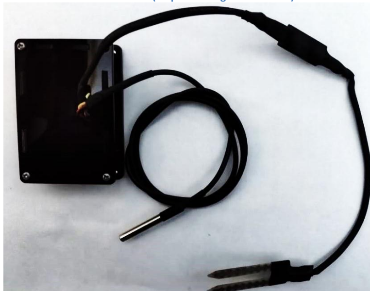
Ilustración 46 (Dispositivo SigFox Terminado)
