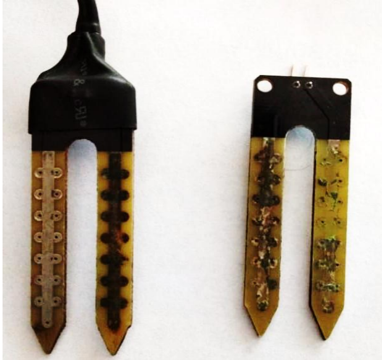
Ilustración 59 (Sensor humedad YL-62 corroído)
