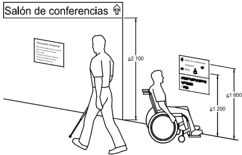
Imagen 9. Altura de la señalización
