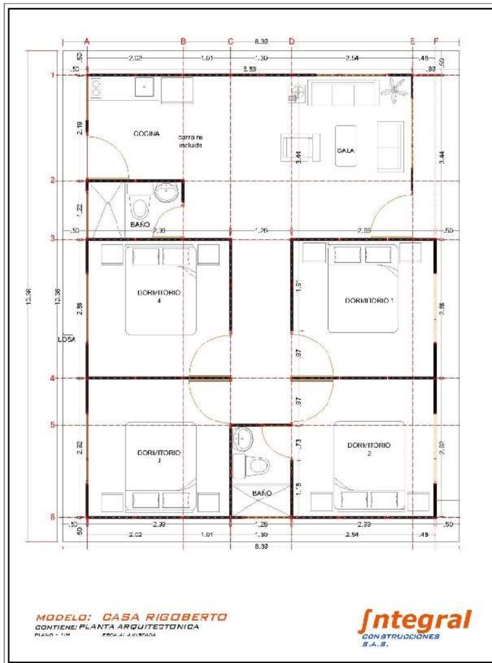
Ilustración 33. Plano arquitectónico vivienda Rigoberto Ome
