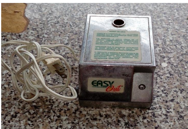
Ilustración 10. Incinerador de Agujas Hospital Nivel I.
