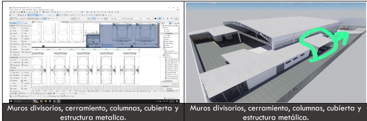
Ilustración 49 Levantamiento 2D y 3D parámetros iniciales y finales entre cliente/ constructora
