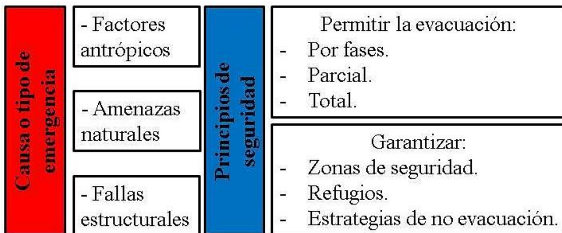
Figura 44. Esquema conceptual de gestión de riesgo y/o desastres naturales en edificaciones patrimoniales (Fuente: elaboración propia, 2018)
