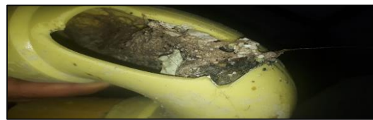
Ilustración # 15. Sifón taponadas
