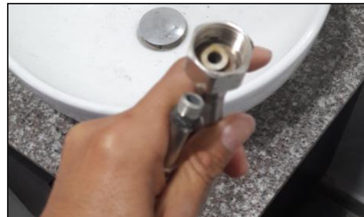
Ilustración # 81. Racor sin empaque
