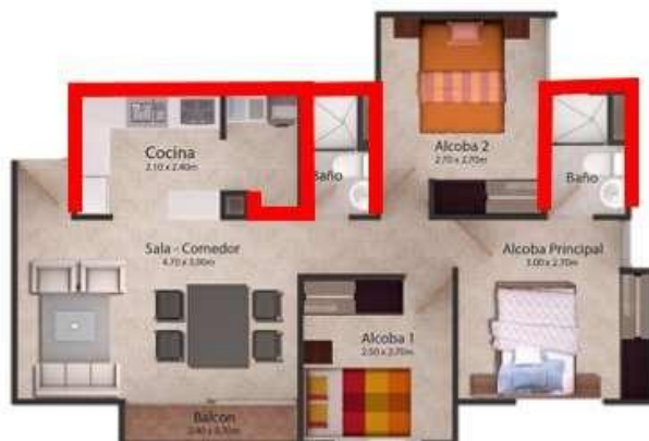
Imagen 17. Planta Tipo – Muros A Repellar.
